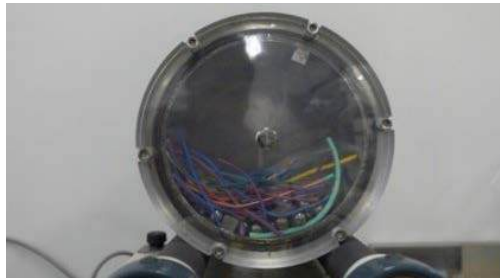
▲有機溶媒によって膨潤した電線剥離の様子
