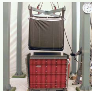
作製した焼却飛灰のセメント固型化物
