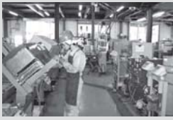
冷蔵庫処理工程 (フロン回収)
